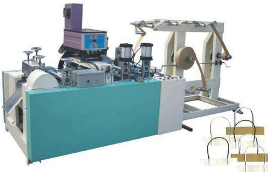
الآلية تستخدم الصمغ المذاب بالحرارة مما يجعل الحوامل أكثر تماسكاً وقدرة على تحمل الأوزان الكبيرة، بالإضافة لسهولة تشغيل الآلة وسرعة في العمل.
