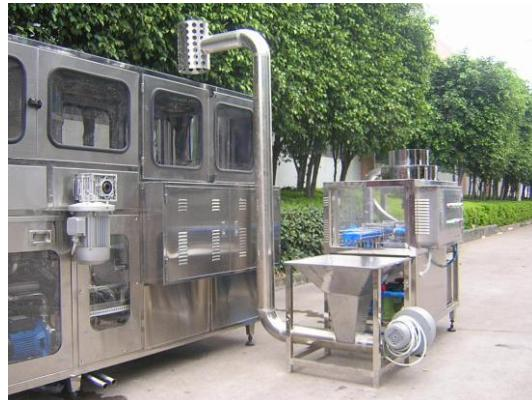
يقوم هذا الجهاز بتعقيم الأغطية قبل استخدامها لتغطية العبوات. يتم التعقيم بواسطة نظام تعقيم بالأشعة فوق البنفسجية UV و غاز الأوزون لقتل الجراثيم و الميكروبات من على الغطاء للتأكد من نظافة و تعقيم عبوة الماء بالكامل.
