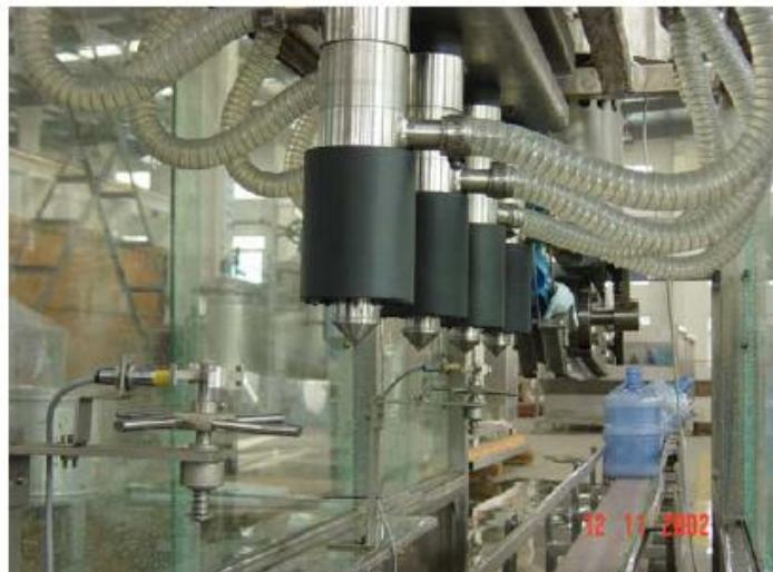
آلية (ثلاثة في واحد) لغسيل و تعبئة و تغطية العبوات تعد هي الآلة الرئيسية في خط تعبئة عبوات المياه. تتتألف الآلة من: الهيكل ، خزان الماء ، أنابيب ، مضخات ، اسطوانات ومكابس ، آليات قيادة ، المعدات الكهربائية. كافية عمليات الآلة أوتوماتيكية بالكامل بدءاً من مراحل الغسيل متعدد الخطوات ، التعبئة الكمية (تعتمد المبدأ الكمي في تحديد كمية الماء) و التغطية الأوتوماتيكية ، حيث يتم ترتيب الأغطية أوتوماتيكياً.
